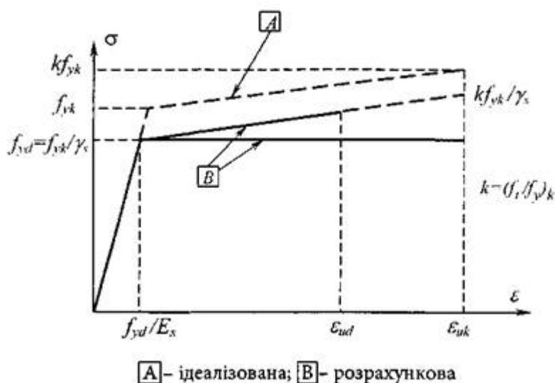
Рисунок 3.6 - Ідеалізована і розрахункова діаграми напруження-деформації для арматури (при розтягу і стиску)
